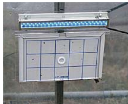
図 4-8 LED を用いた害虫の誘殺トラップ
