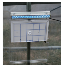
＜LEDを用いた害虫の誘殺トラップ＞
