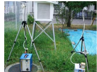
大気中の石綿濃度測定
