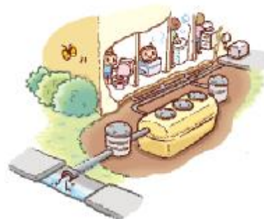
合併処理浄化槽設置イメージ
