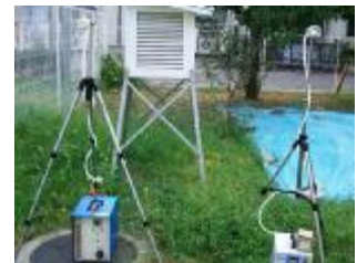
大気中の石綿濃度測定
