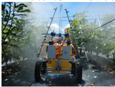
▲ロボットによる農薬散布風景
