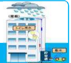
貯留槽に溜めた雨水をトイレ用水・散水等に利用
