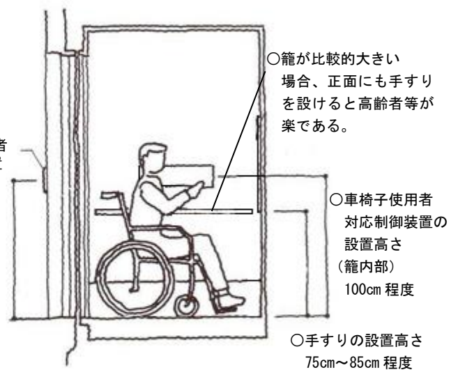
○図 6.4 手すりや制御装置の高さ
