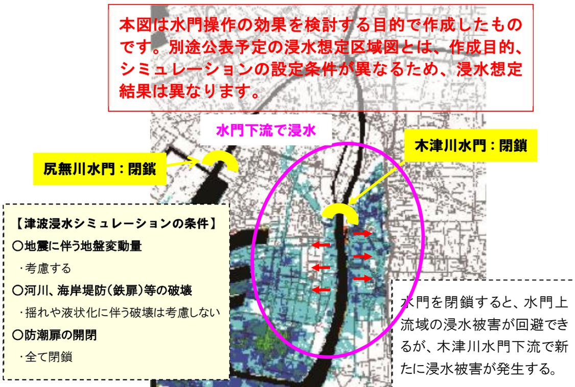
図-2.10 最大クラス相当の津波によるシミュレーション結果（全水門閉鎖）
