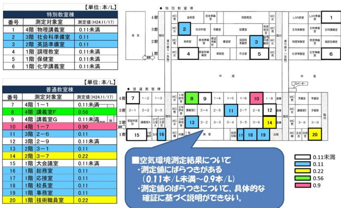
図表 2-50 平成 24 年 11 月 17 日 アスベスト気中濃度測定結果
