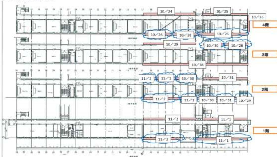
図 2-4 軒裏撤去工事の位置と工事日(H24/10/24～11/2)
