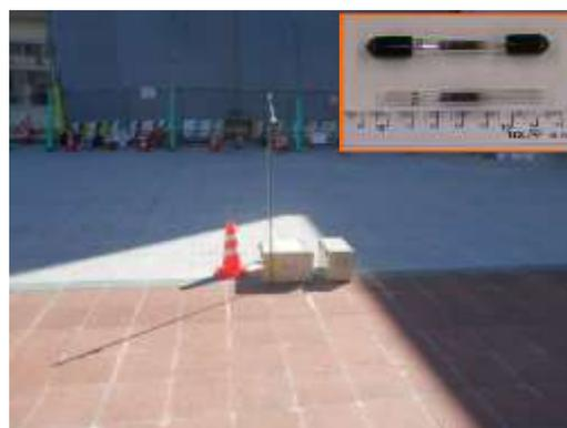
図 3.3-3 捕集機器の設置状況と捕集管
