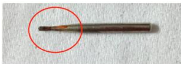
図8 除去用バーに生じたもらい錆
