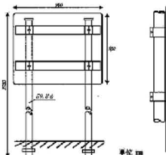
標示板 / アルミ板 : アルミ平リブ付、デジタルプリント印刷、支柱取付金具付
