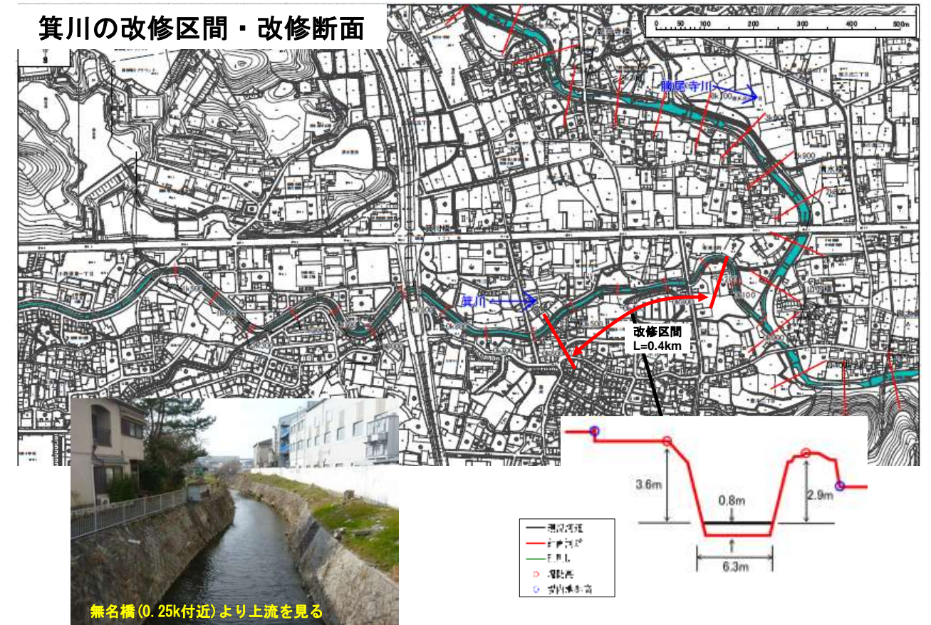
図-1.218 河道改修(河道掘削案)の概要
