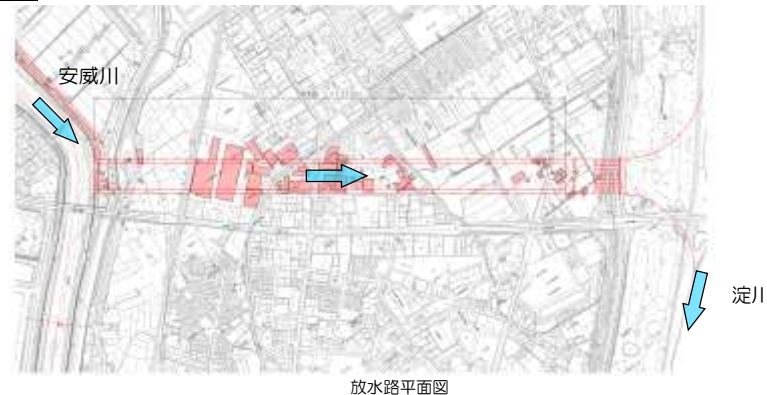
図-1.157 河道改修案+放水路案の概要
