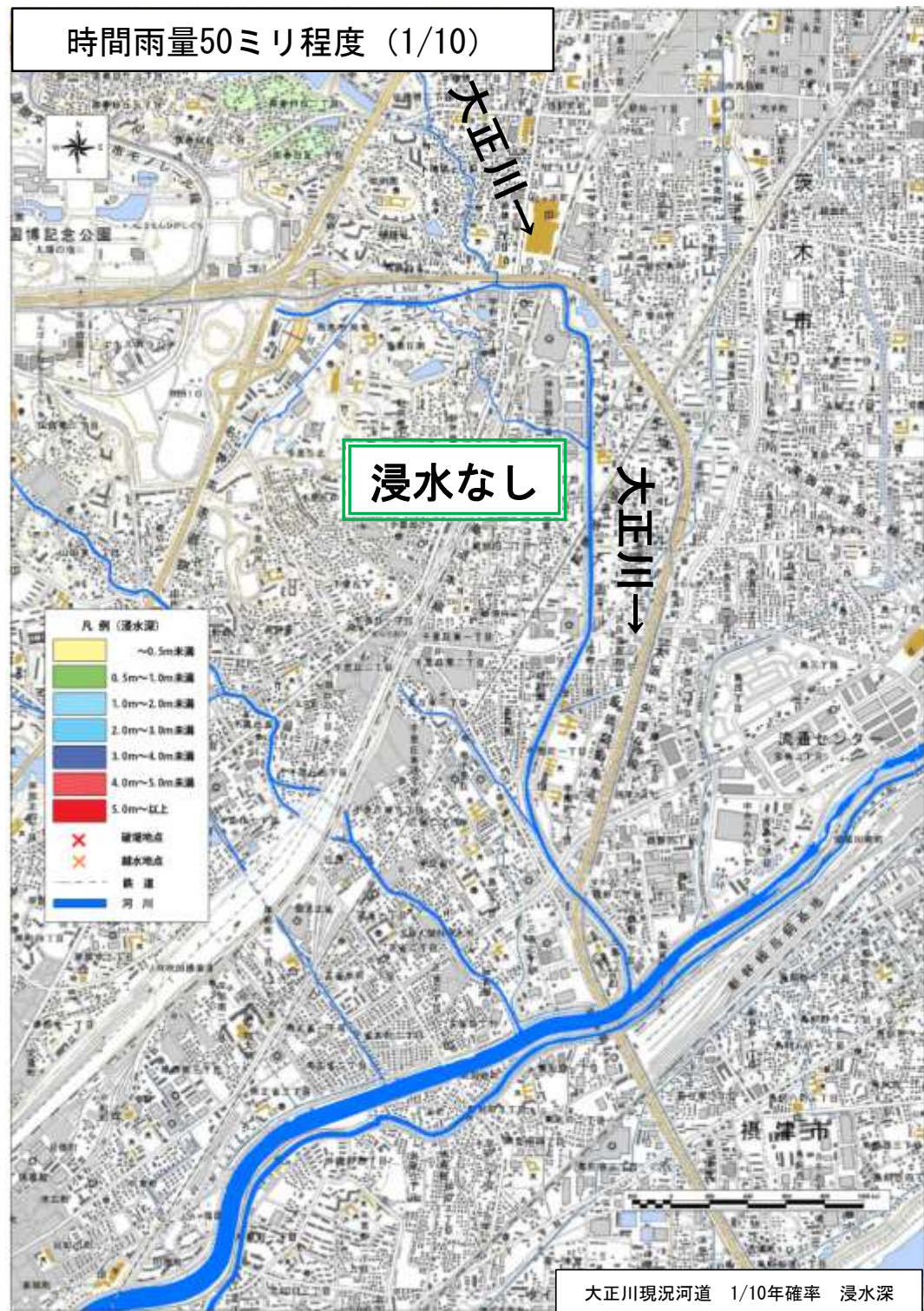
※被害最大となる破堤地点での破堤を想定 (1洪水) 図-1.175 現況河道における氾濫解析結果 (時間雨量 50 ミリ程度)
