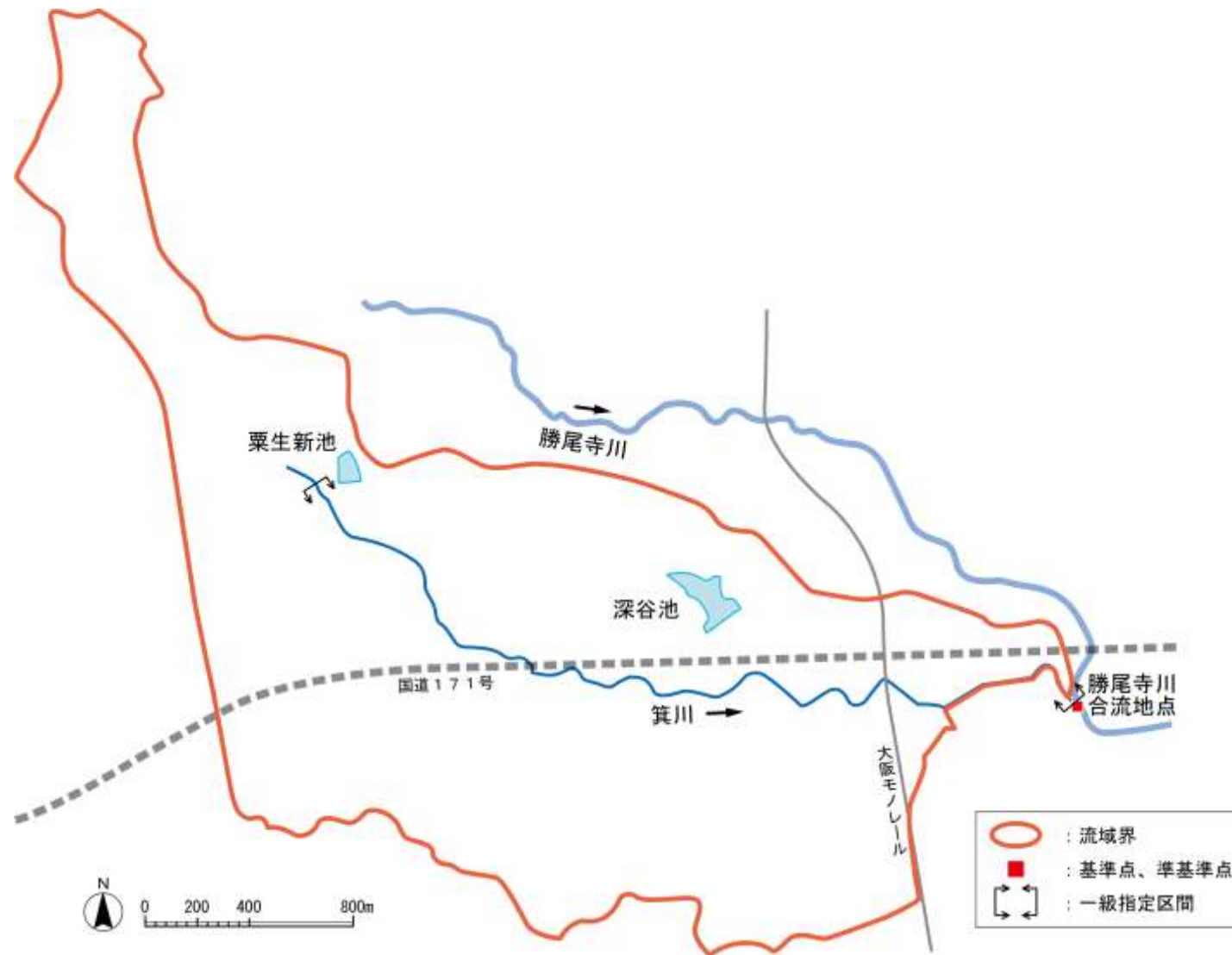
図-1.219 箕川流域の流出抑制効果が期待できるため池（現時点での候補地）
