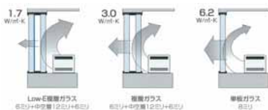
熱貫流率による断熱性能の比較(複層ガラス)
